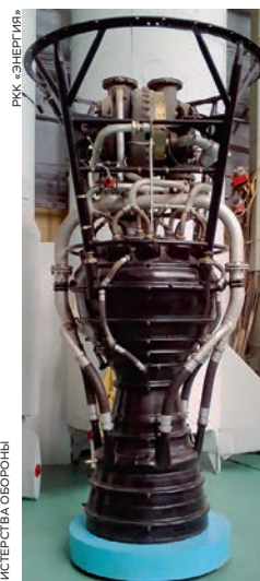
— Двигатель РД-103М ракеты Р-5М в музее РКК «Энергия»
