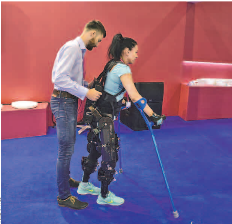
Экзоскелет позволяет двигаться людям, прикованным к инвалидной коляске
