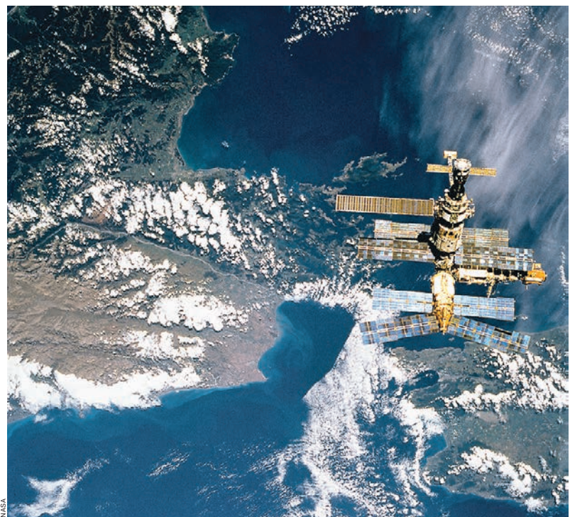
На алюминиевые сплавы приходится 50–90% массы всех космических аппаратов, включая первый искусственный спутник Земли «Спутник-1» (1957), корабль «Восток-1» Юрия Гагарина (1961), советскую станцию «Мир» (на фото) (1986–2001) и Международную космическую станцию, работающую уже четверть века на орбите
